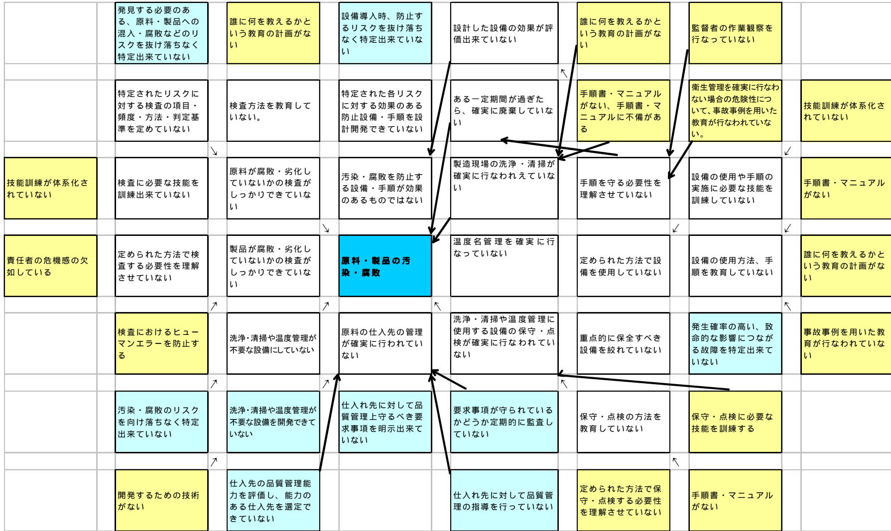
図 2.4 原料・製品の汚染・腐敗に関する連関図
